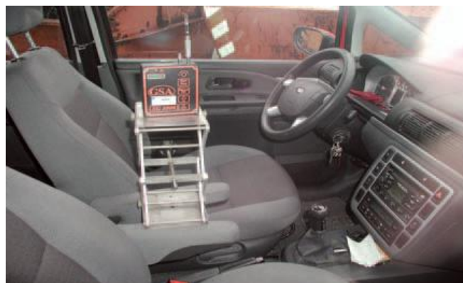
Μέτρηση στο εσωτερικό του οχήματος για βλαβερά αέρια
